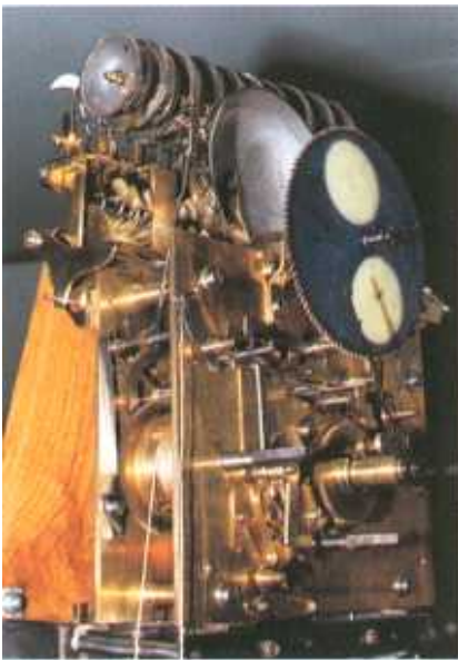
Abb. 4: Unterzifferblattansicht mit der Mondphase
