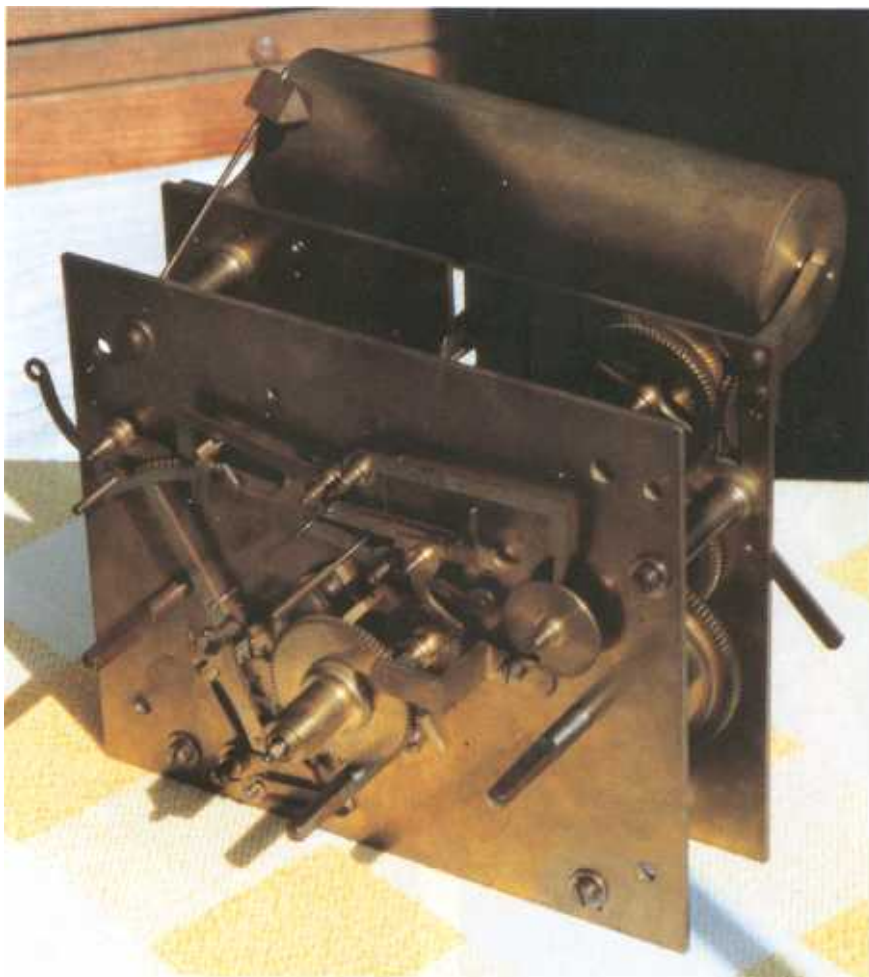
Abb. 1: Das Uhrwerk mit Musikwalze wie es beim Trödler gefunden wurde
