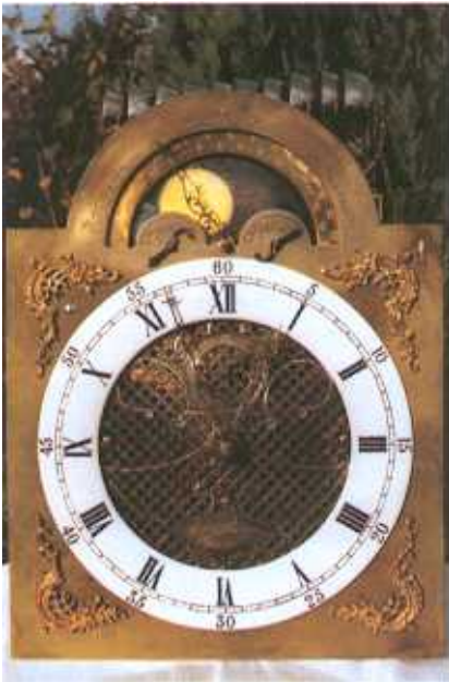
Abb. 2: Zifferblatt mit Emailring. Mondphasen, Zeiger für die Musikstücke und Schlagwerk-Abstimmung
